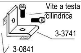
Vite a testa cilindrica
